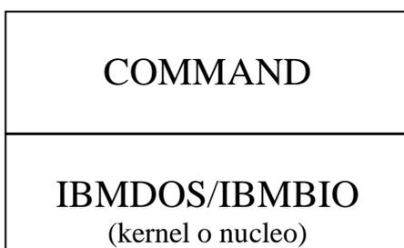
Il file IBMBIO e' la parte del DOS orientata al livello immediatamente inferiore cioe' al Bios mentre il file IBMDOS e' la parte orientata al livello superiore cioe' quello applicativo.
